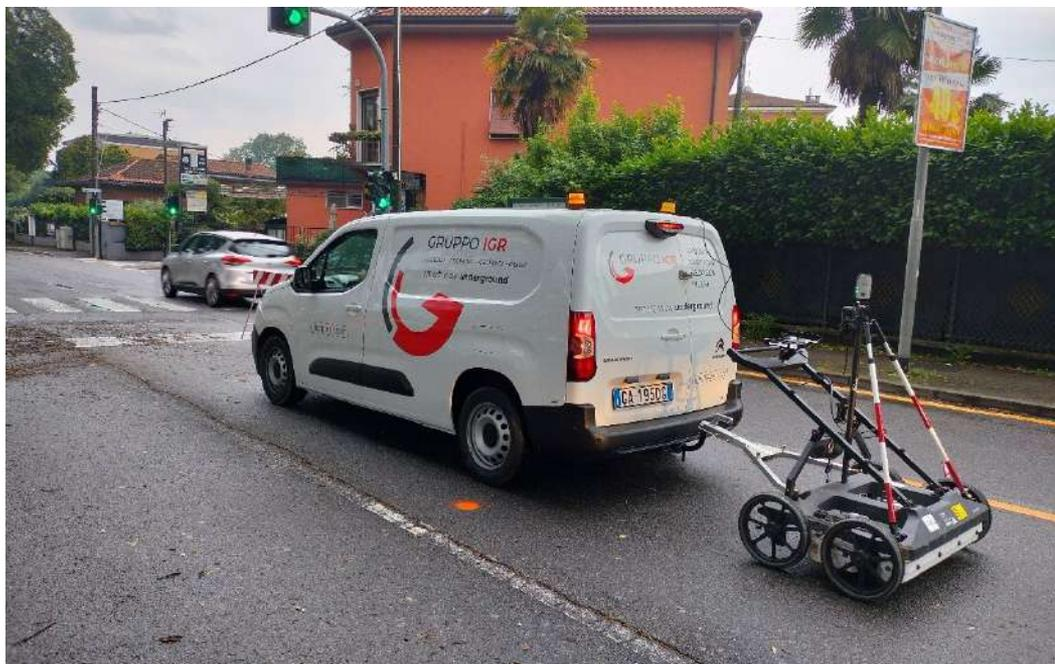
Nei mesi successivi è partito un programma di monitoraggio che ha previsto, con cadenza bimestrale, l'esecuzione di Indagini Georadar (GPR).
